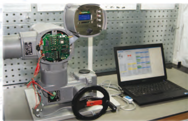
Fot. 4. Podłączony napęd SA 07.1 z AM01.1
