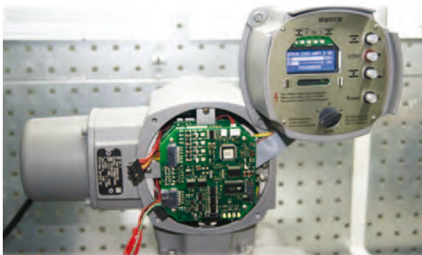
Fot. 12. Widok wartości E1 i E2 na wyświetlaczu sterownika (opcja sterowania SetPoint)
