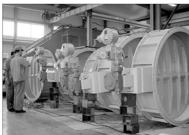
Ilustracja 5. Przepustnice o średnicy DN 1800 na ciśnieniu PN 1,6 z napędem ze zmienną prędkością obrotową do regulacji dopływu powietrza do pieca hutniczego
