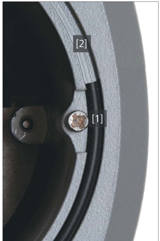
Ilustracja 2. Odcięta uszczelka [1] pozwala zobaczyć, że powłoka sięga aż za krawędź uszczelniającą [2]
