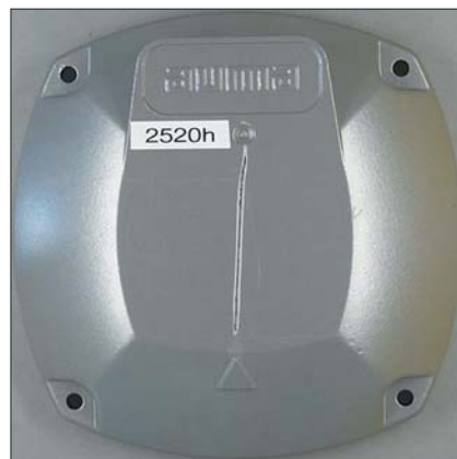
Ilustracja 5. Pokrywa po trwającym 2520 godzin teście z wykorzystaniem mgły solnej. Przy rysie nie są widoczne żadne szkody korozyjne.
