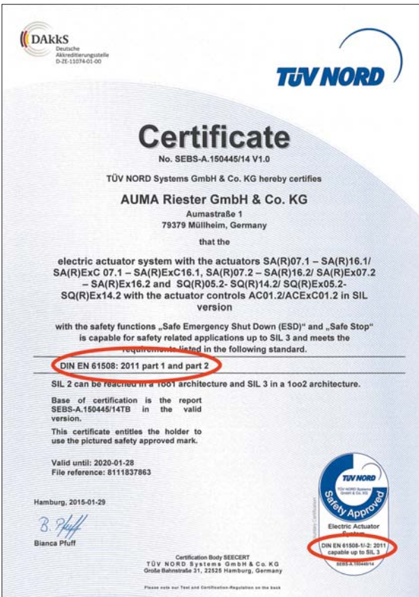
Ilustracja 5. Certyfikat napędów ze sterownikiem AC.2 SIL firmy AUMA potwierdzający zgodność z normą PN-EN 61508 w wersji z 2011 roku, co odpowiada wydaniu drugiemu
