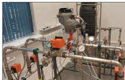
Rys. 1. Stanowisko przepływowe dla elementów nastawczych, aktuatorów i układów sterownia Fig. 1. Flow station for adjusting elements, actuators and control systems
