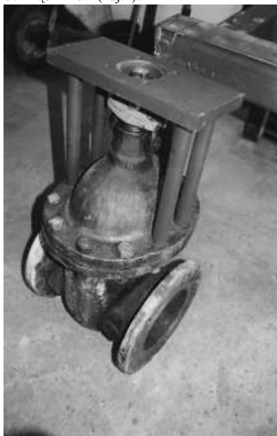
Zdj.2 - Adapter po montażu na zaworze
