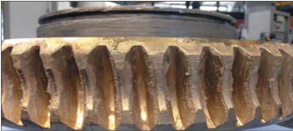
Ilustracja 6. Koło ślimakowe pokryte smarem adhezyjnym przyjaznym dla środowiska
